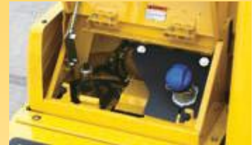
Kolay erişim için AdBlue® tankı ön merdivene monte edilmiştir.
