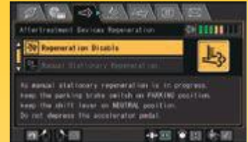
KDPF için son işlem cihazı rejenerasyon ekranı
