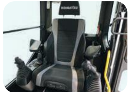
En üst kalite minder, otomatik ağırlık ayarı, bel desteği, klima kontrol sistemi, isteğe bağlı çok konumlu kolçaklar ve ergonomik kontrol kolları ile sunulan isteğe bağlı premium koltuk
