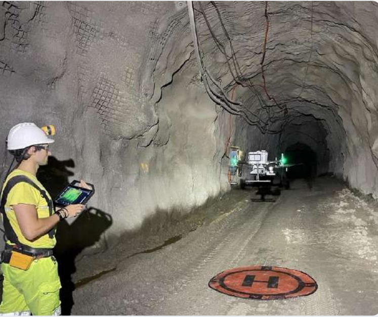
Exyn Nexys, DJI350 ile otonom taramayı destekliyor.
